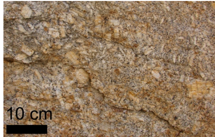
Figura 10 – Granito de Castelo Branco usado na construção da muralha
